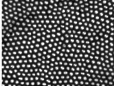
Figure 17 : Inhomogénéité d'un guide d'image multi-cœur.
