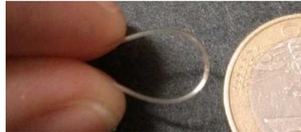
Figure 44 : Flexibilité de la fibre du PhLAM.
