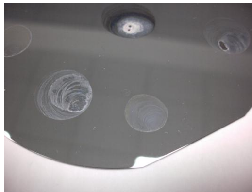
Fig A-32 : Aspect des gouttes séchées sur wafer de silicium. La couleur blanchâtre est due aux résidus carbonés de CTAB.
