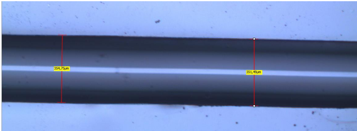
Fig 1-62 : Canal dont la déviation ne dépasse pas 3%.
