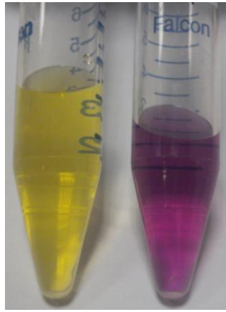
Fig 3-89 : Changement de couleur d'une solution de xylénol en fonction du pH (à gauche pH=2, à droite pH=8). Puisque le but est d'observer une variation de couleur vers le rose/rouge lors d'une éventuelle complexation, on constate qu'il vaut mieux utiliser l'indicateur colorimétrique à pH acide.
