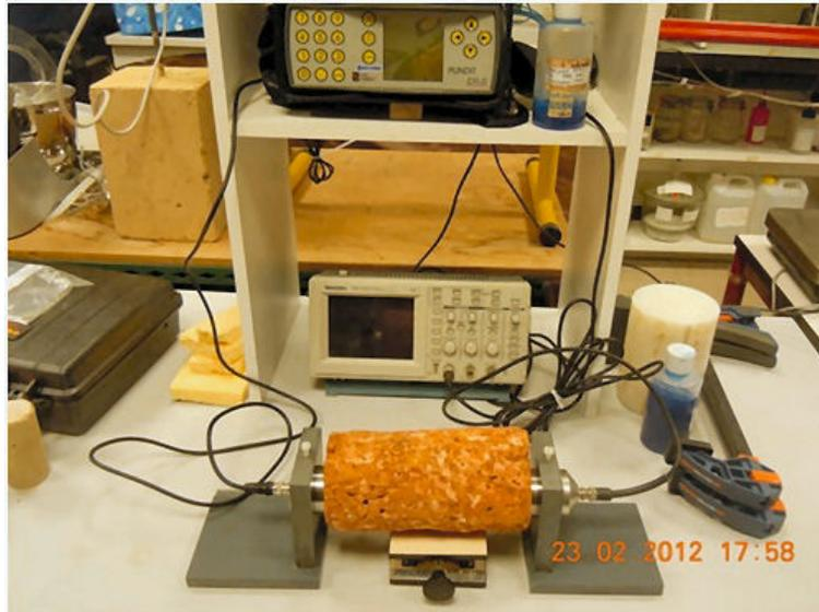
FIGURE 3.19 – Dispositif utilisé pour la mesure de vitesse de l'onde P (PUNDIT)
