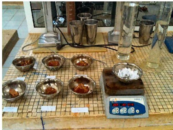
FIGURE 3.14 – Dispositif de mesure de volume par la méthode de la paraffine
