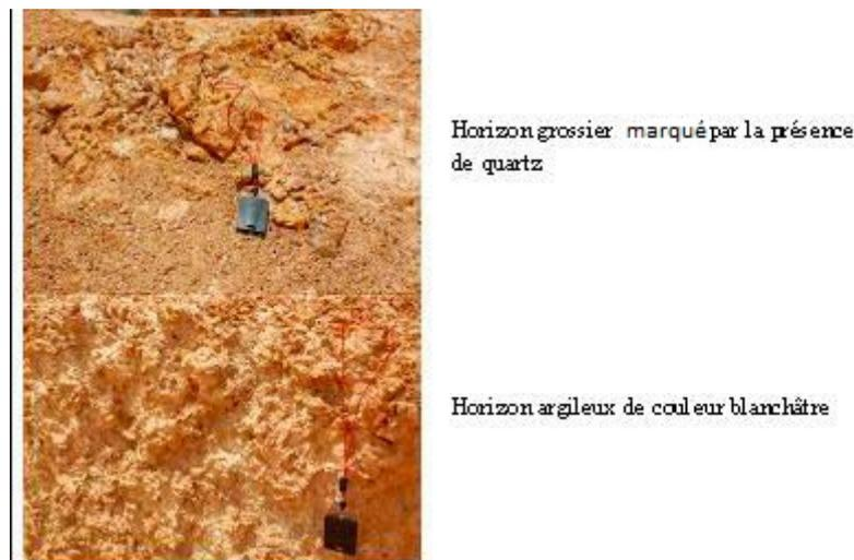
FIGURE 2.12 – Profil observé sur une tranchée routière
