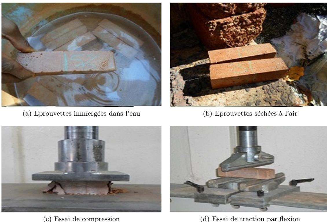
FIGURE 4.14 – Eprouvettes 4 x 4 x 16 cm de mortier de latérite-ciment et essais de compression-traction par flexion
