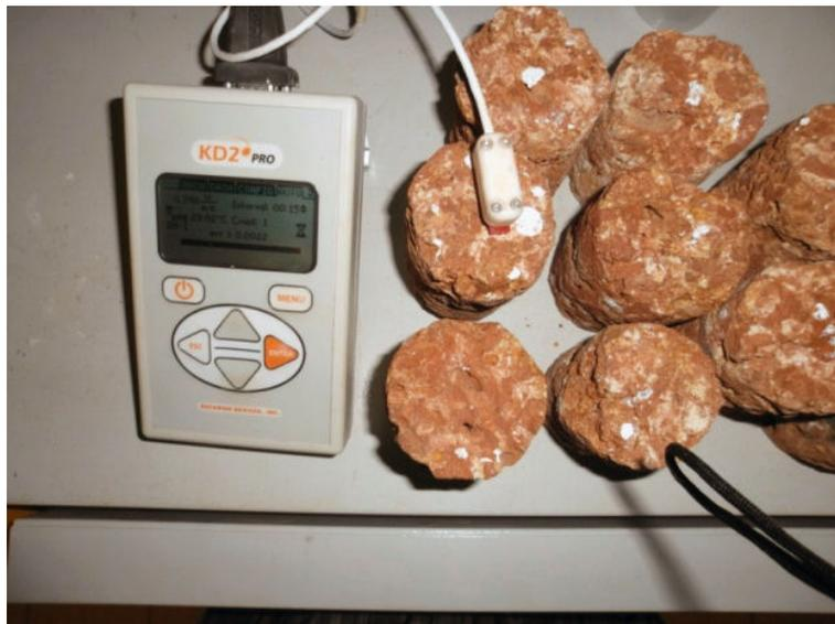
FIGURE 3.23 – Dispositif de mesure KD2 Pro
