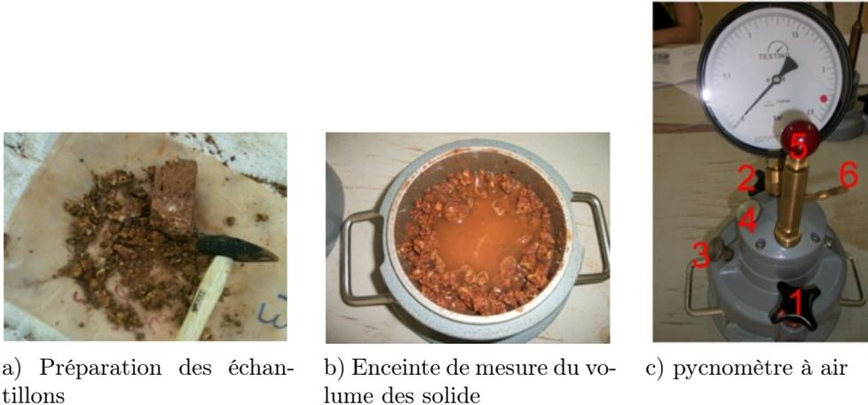
FIGURE 3.15 – Dispositif de mesure de la masse volumique absolue
