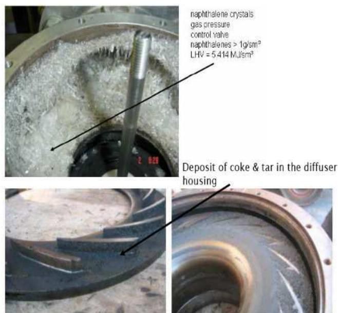
Figure 1.13 – Photographies de dépôt de goudrons dans le circuit d'une chaudière [102].
