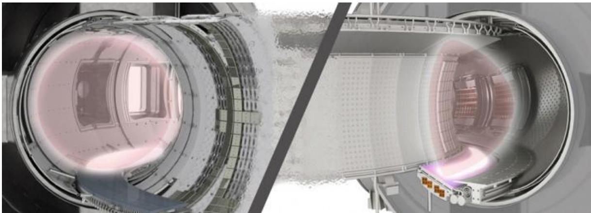
**Figure I-16. Enceinte de Tore Supra dans sa configuration actuelle (à gauche) et dans sa configuration divertor pour le projet WEST (à droite).**
