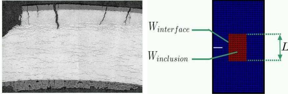
FIGURE 2.12 – Fissuration mécanique. A gauche, image en coupe d’une gaine de combustible avec présence de fissures, à droite, cas test simplifié (le segment blanc représente une initiation de fissure).
