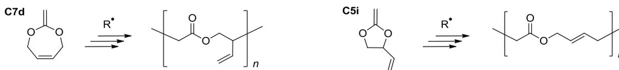
Figure 84: Polymérisations des 2-méthylène-1,3-dioxé-5-pène (C7d) et 2-méthylène-4-vinyl-1,3-dioxolane (C5i)
