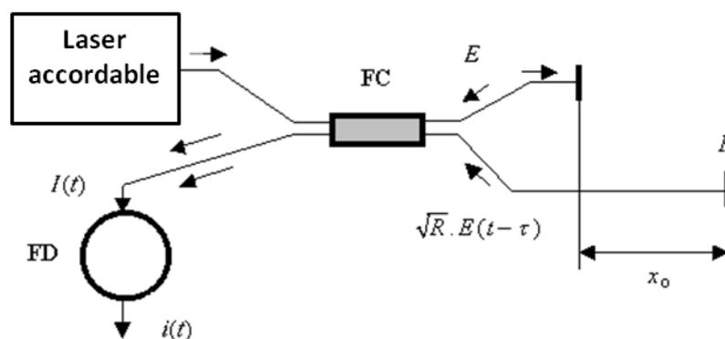
Figure VI-4 : schéma du montage de l'OFDR
