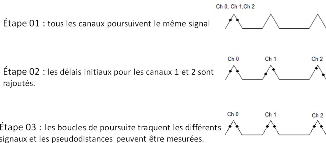
**Figure IX-3 : processus de calibration**
