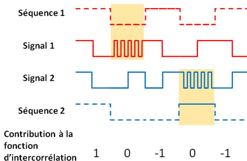
Figure III-1 : exemple de corrélation entre deux codes partiellement modulés en BOC
