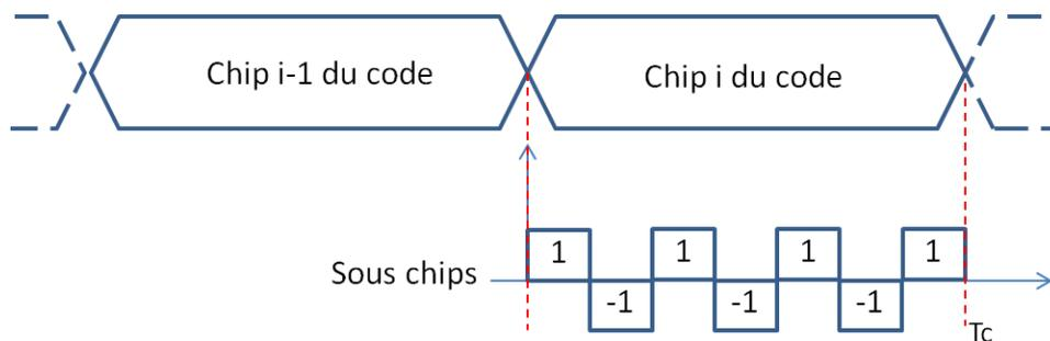
Figure I-7 : schéma de la modulation  $BCS([1,-1, 1,-1, 1,-1,1], f_c)$
