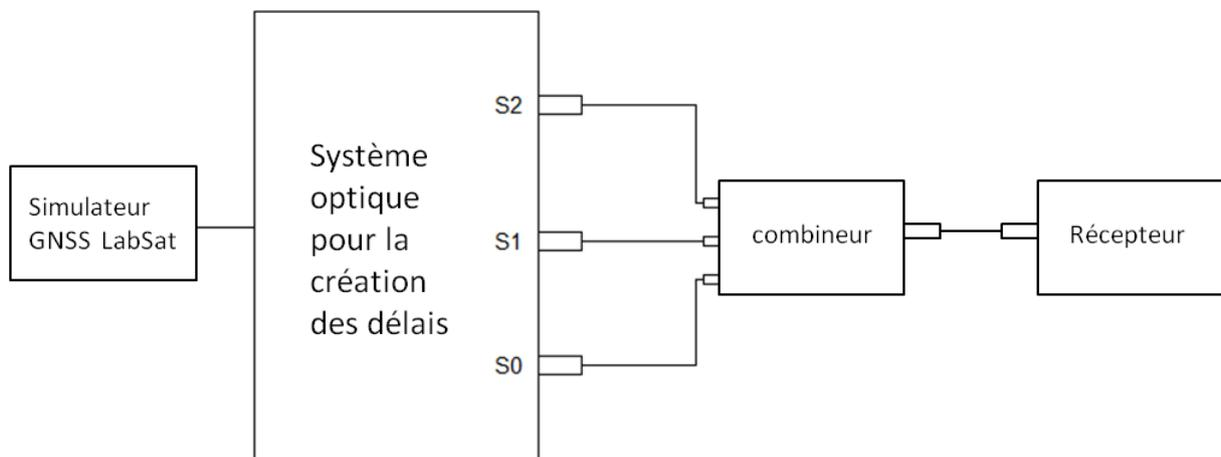
**Figure IX-2 : Montage de calibration du système.**
