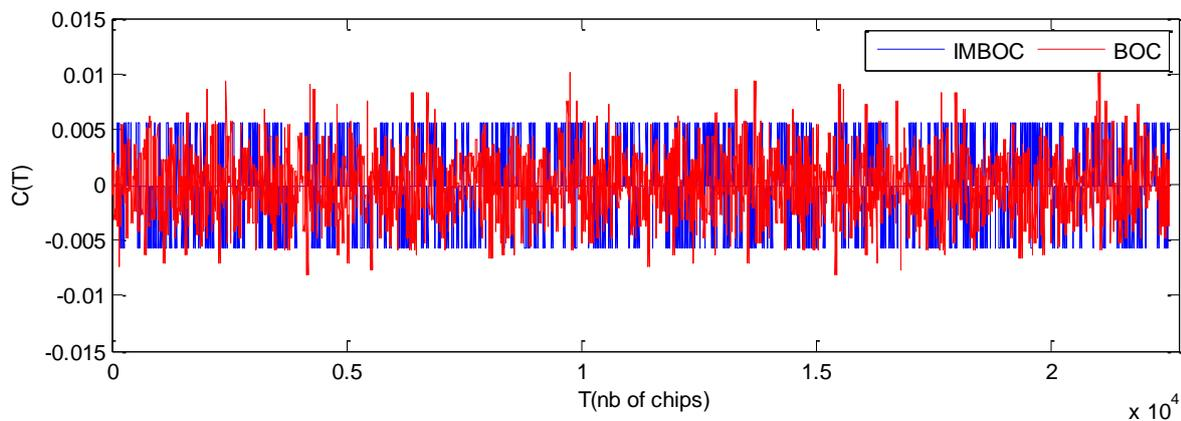
**Figure III-11 : fonction d'intercorrélations entre la version BOC et IMBOC ( $p=11$ ) de la séquence maximale G1 les codes GPS.**
