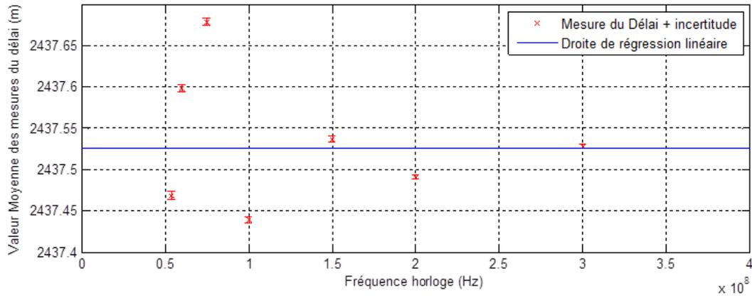
Figure VIII-6 : Tracé de la droite de régression linéaire pour le délai  $S_0-S_3$
