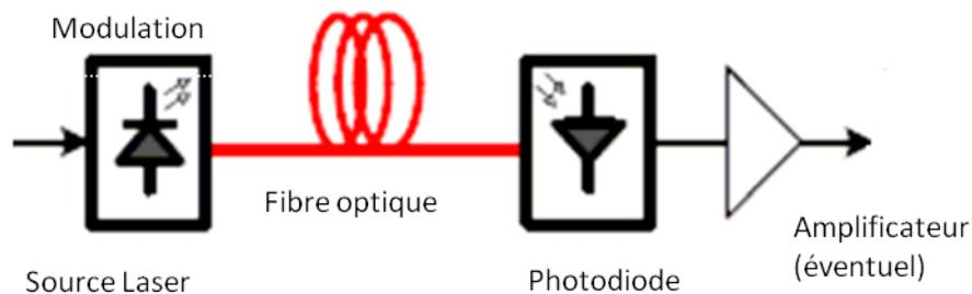
Figure V-3 : montage de transmission sur fibre optique
