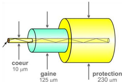
Figure V-1 : Schéma de la fibre monomode.
