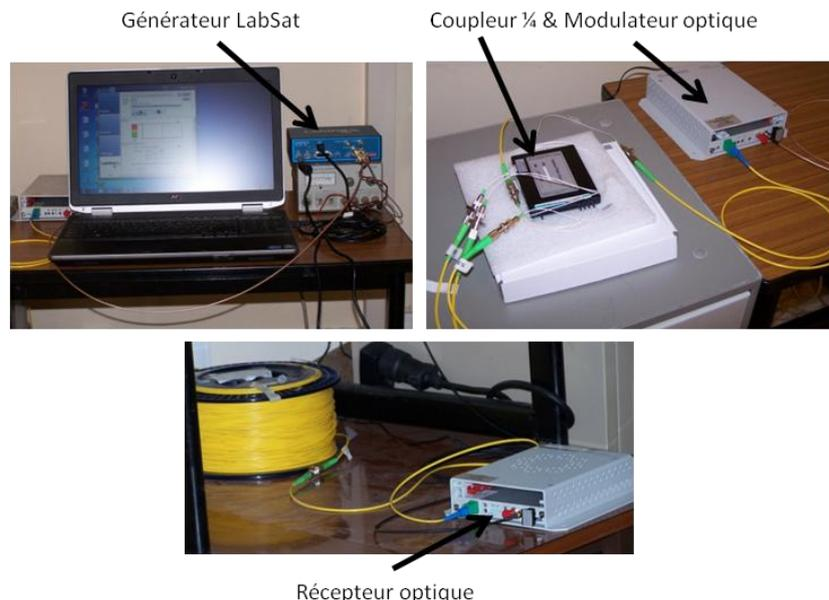
**Figure IX-7 : montage du système de localisation**
