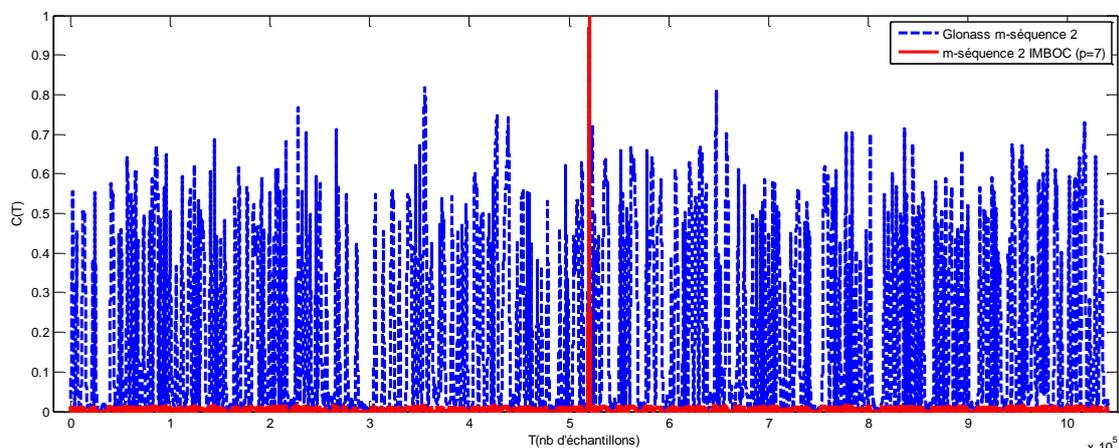
**Figure III-25:** fonction d'autocorrélation du signal Glonass reçu à la position de test PT4 quand la seconde m-séquence ou sa version modulée en IMBOC ( $p=7$ ) est émise par les répéteurs en indoor
