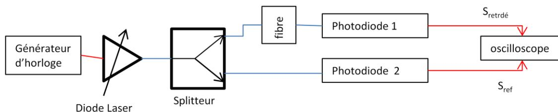
Figure VI-7 : schéma de principe de la procédure expérimentale
