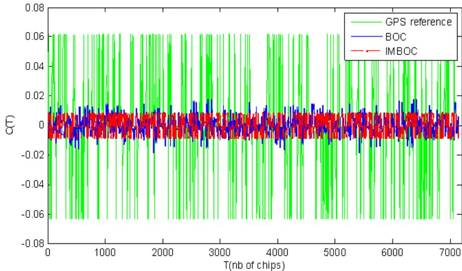
**Figure III-10 : fonction d'intercorrélation de la séquence maximale générée par décimation et modulée en BOC et IMBOC pour  $p$  égale à 7 avec la séquence de Glonass**
