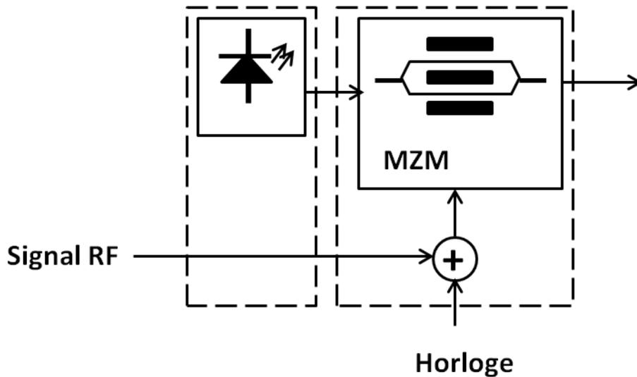
Figure V-6 : montage de la modulation externe
