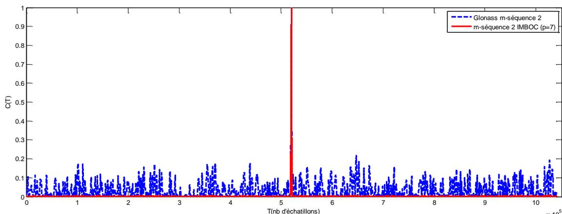
**Figure III-24 :** fonction d'autocorrélation du signal Glonass reçu à la position de test PT1 quand la seconde m-séquence ou sa version modulée en IMBOC ( $p=7$ ) est émise par les répéteurs en indoor
