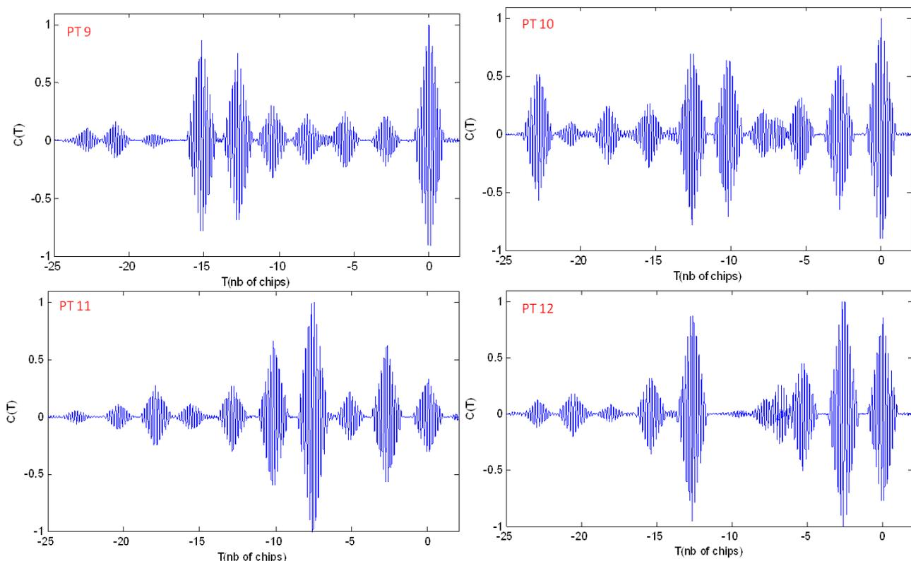
**Figure III-26 : les fonctions d'autocorrélation des 10 répélites tracées pour les points de test indoor du PT9 au PT12.**
