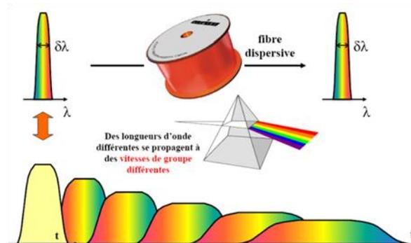
Figure V-2 : dispersion chromatique sur la fibre monomode
