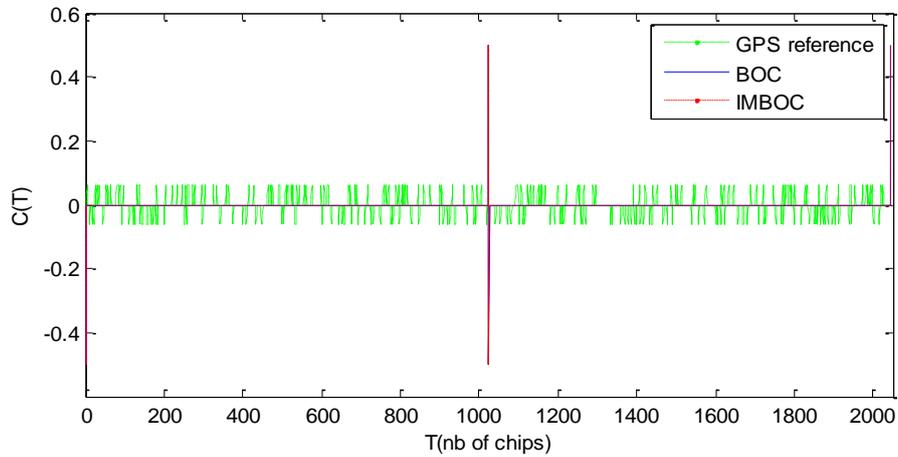
**Figure III-5 : fonction d'intercorrélation de la séquence maximale de Glonass et celle modulée en BOC et IMBOC avec  $p=2$**
