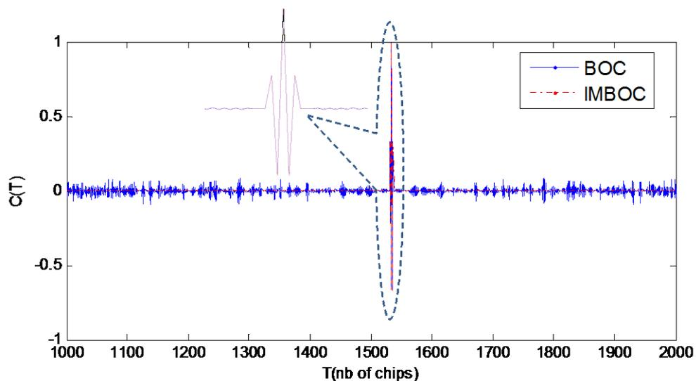
Figure III-4 : fonction d'autocorrélation de la séquence maximale de Glonass modulée en BOC et IMBOC avec  $p=3$
