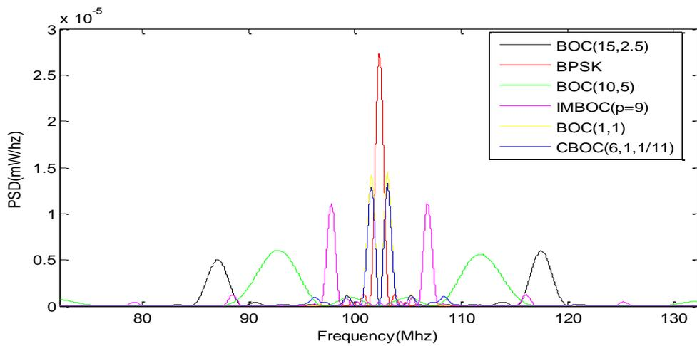
Figure III-15 : les spectres des signaux GPS et Galileo de la bande L1 avec le nouveau signal IMBOC pour  $p = 9$ .
