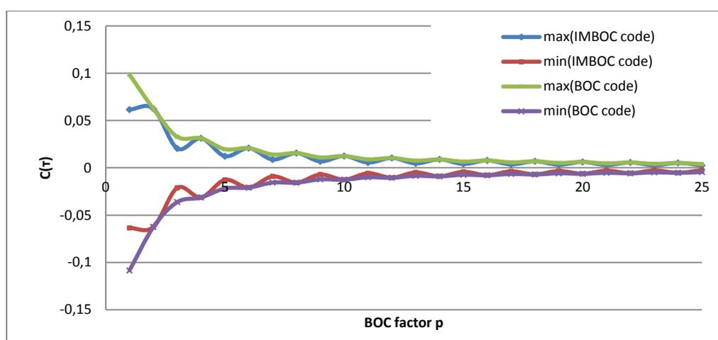
Figure III-13 : les valeurs maximales et minimales des fonctions d’intercorrélation des modulations BOC et IMBOC pour la bande GPS
