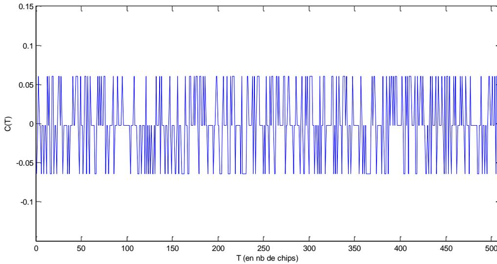
**Figure II-1 : Fonction d'intercorrélacion entre la séquence de Glonass et celle décimée à  $d=2^1+1$**
