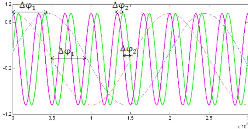
Figure VII-2 : notion d'ambiguïté dans la mesure de déphasage
