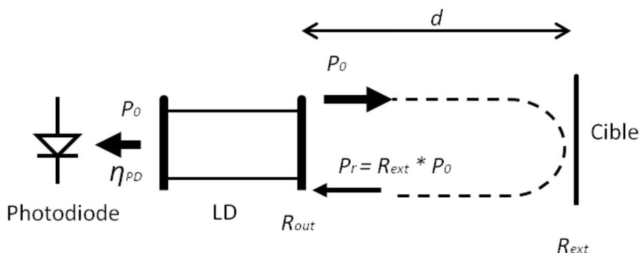
Figure VI-6 : la méthode « self mixing interferometry »
