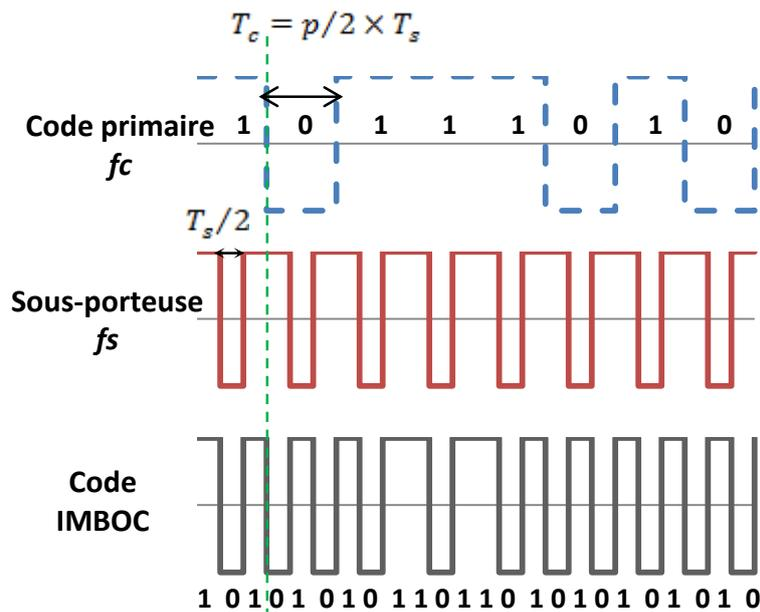
Figure III-2 : exemple de modulation IMBOC avec  $p=3$
