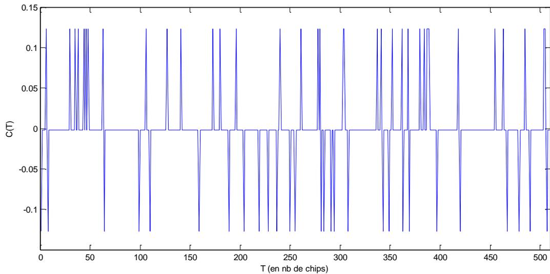
**Figure II-2 : Fonction d'intercorrélacion entre la séquence de Glonass et la séquence décimée à  $d=2^3+1$**
