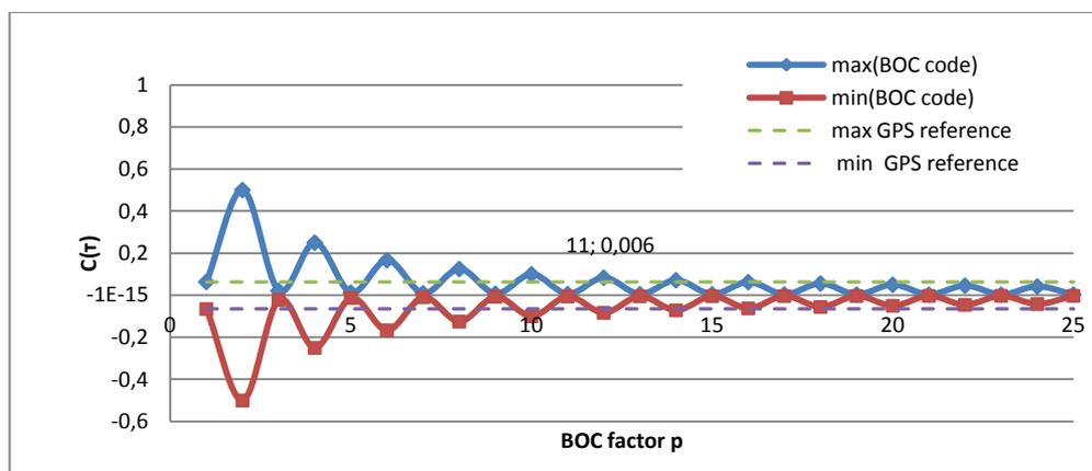
Figure III-8 : les valeurs maximales et minimales de la fonction d'intercorrélation entre la séquence de Glonass et sa réplique modulée en BOC pour  $p \in [1 \ 25]$
