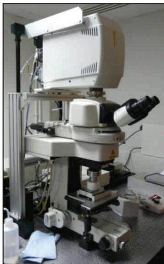
**Figure 90** : Microscope confocal biphotonique A1R MP PLUS (Nikon Instruments, Champigny sur Marne, France), disponible à l'Equipex IVTV à l'Ecole Centrale de Lyon. Le microscope est équipé d'un objectif apochromatique Nikon Lambda-S 25x et d'un microscope droit FN1.
