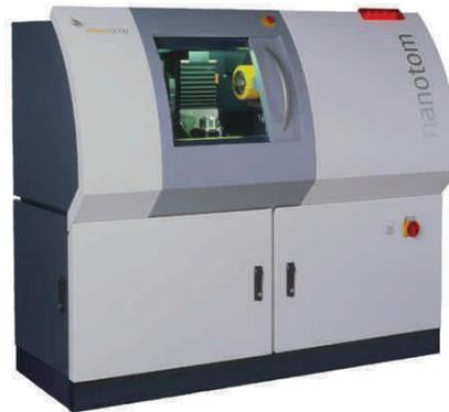
**Figure 71 : Microtomographe X Phoenix Nanotom utilisé pour l'observation.**
