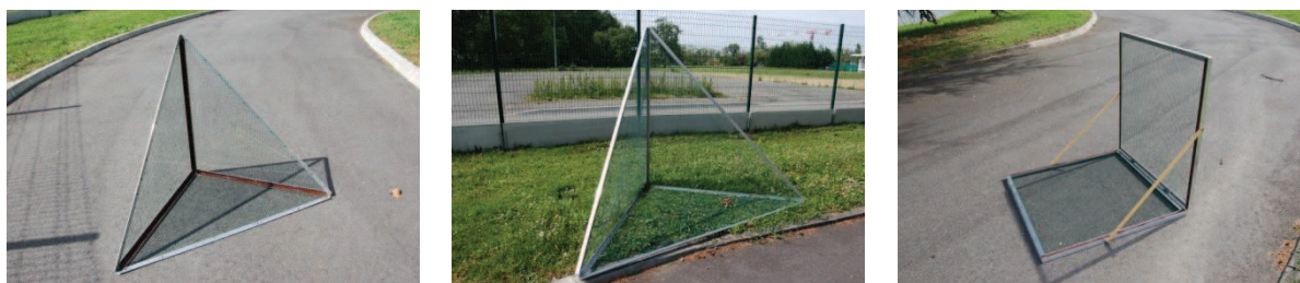
Figure 14. TreeScat : Réflecteurs trièdre à face triangulaire de 1 m d'arrête (gauche) et de 1,80 m d'arrête (milieu) et dièdre pliable de faces de 1 m par 1 m (droite) utilisés pour valider les mesures.
