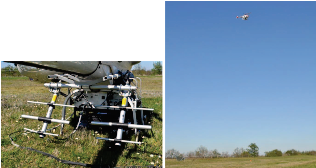
Figure 25. Antennes et VNA installés sur le drone (gauche) et drone instrumenté en vol lors d'une acquisition sur le trièdre (droite).
