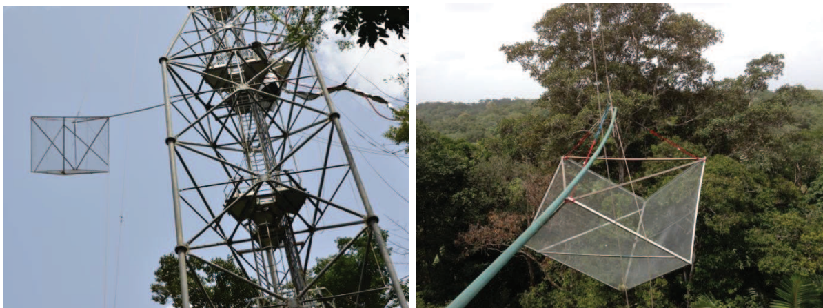
Figure 16. TropiScat : Essai de calibration avec le réflecteur trièdre suspendu à 25 m de haut.
