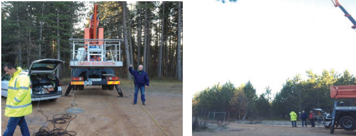
Figure 20. PC de pilotage dans le coffre de la voiture et nacelle équipée du VNA et des antennes (gauche) et mesure de validation du système d'acquisition à l'aide d'un réflecteur radar (droite).
