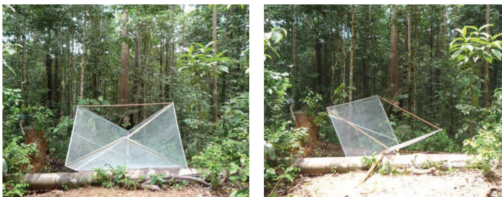
Figure 15. TropiScat : Réflecteurs trièdre à face carrées de 2 m d'arrête (gauche) et dièdre à face carrées de 2 m de côté (droite) utilisés pour valider les mesures.
