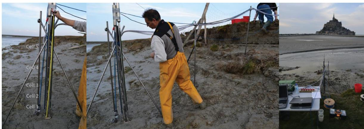
**Figure A : Dispositif de calibration in-situ**
