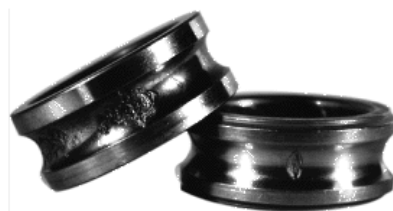
(a) défaut : écaillage de la bague interne
