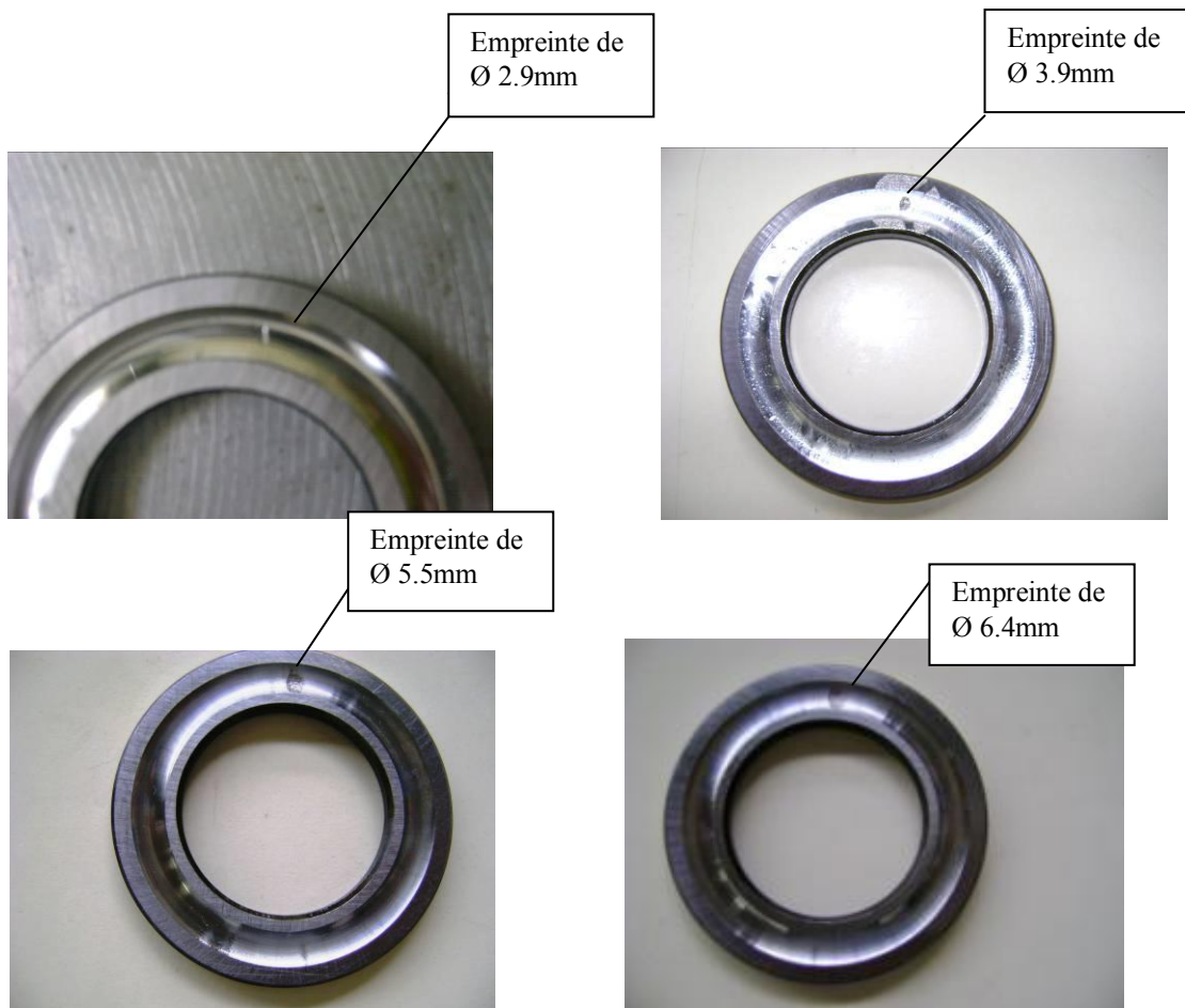
Figure 3.12: Simulation de différentes empreintes sur une bague d'un roulement de butée
