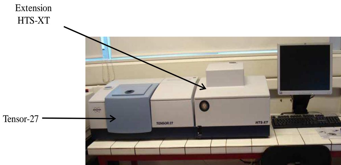
**Figure 27 : Le spectromètre IRTF Tensor 27 couplé au module HTS-XT à haut débit.**
