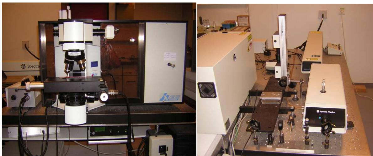
**Figure 22 : Micro-spectromètre Raman LabRam 785 nm.**
