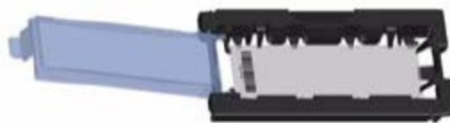
Figure 111 : Positionnement de la lame dans les cassettes
