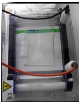
Figure 110: Migration sur gel d'Agarose 1% dans le cadre du control qualité après extraction d'ADN
