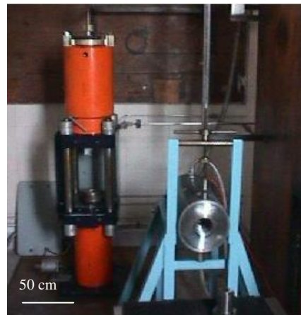
Figure 3 : Autoclave à chauffage interne de l'ENS Paris : enceinte de pression à droite et multiplicateur de pression à gauche. Photo de Fabrice Brunet.
