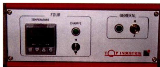
Figure 2-9 : Coffret de commande
