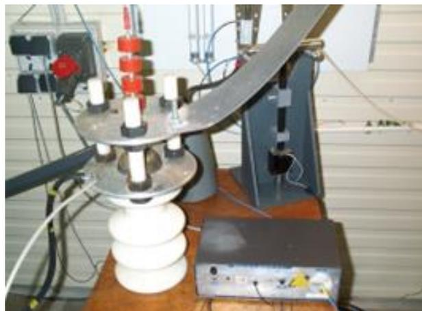
Figure 2-3 : Commutateur associé à son système de déclenchement
