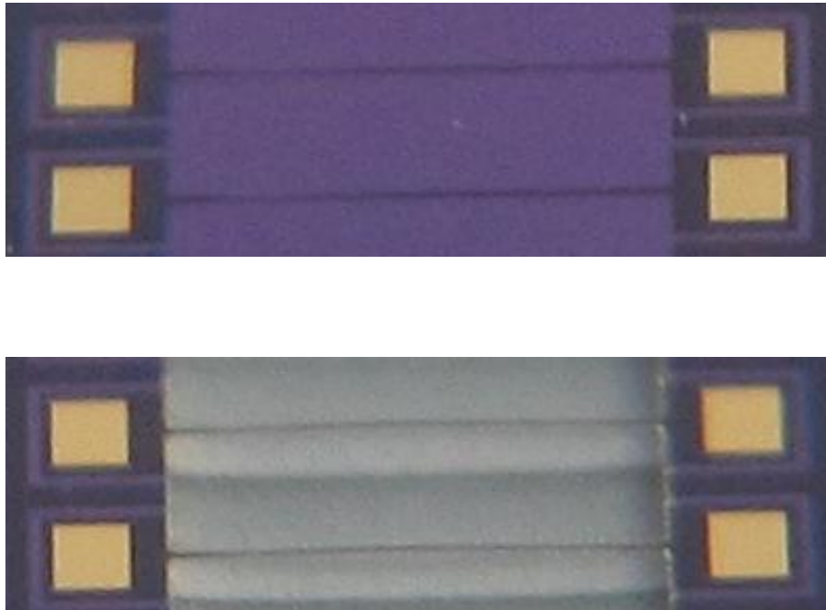
Figure 6.1 : Photographies du micro-filament SOI non libéré (en haut) et libéré (en bas).
