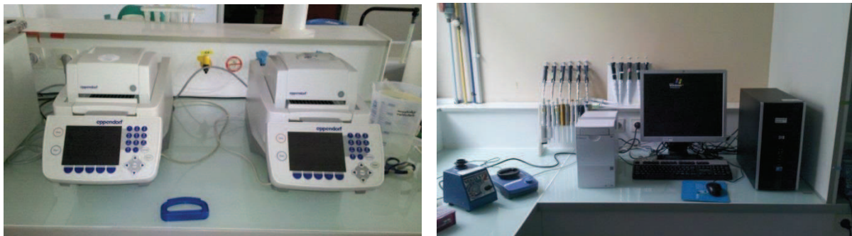
Figure I-11 : à gauche : Mastercycler epgradient S (Eppendorf) pour l'amplification de l'ADN par PCR, à droite : Bioanalyzer 2100 (Agilent) pour l'analyse des produits de PCR.
