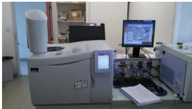
Figure I-7 : Chromatographe GC Clarus 580 (Perkin Elmer) et son passeur automatique
