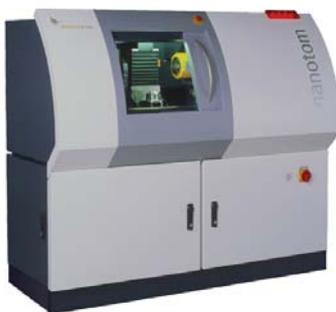
FIGURE 2.4.2 – Photographie du tomographe aux rayons X
