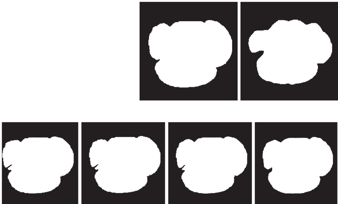
FIGURE 9.1 – Illustration des résultats du recalage de la Paire 1 par différents termes de régularisation. 1 ère ligne (de gauche à droite) image Reference et image Template . 2 ème ligne (de gauche à droite) : image obtenue après recalage par un modèle non linéaire, un modèle de diffusion, un modèle avec régularisation biharmonique et un modèle non linéaire fondé sur le matériau de type Saint Venant-Kirchhoff. Figure provenant de [89].
