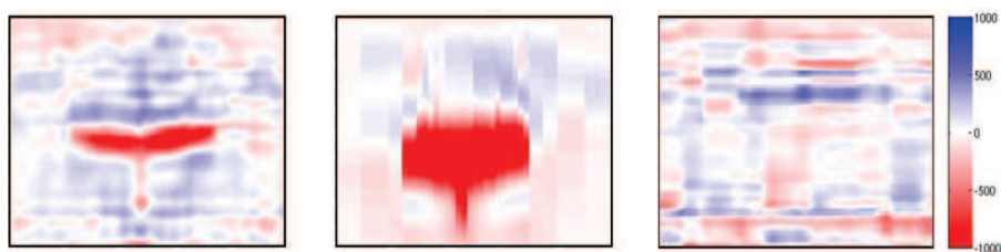
FIGURE 3.1 – Comparaison de la fonction objectif sur un cas d'injection de vapeur. Gauche : variations d'impédances P de référence. Centre : variations d'impédances P simulées avec injection de vapeur. Droite : variations d'impédances P simulées sans injection de vapeur (en g.cm^{-3}.m.s^{-2} ).
