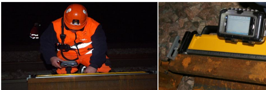
Figure 1. 9. Contrôle d'about de rail au moyen d'un recti-way.
