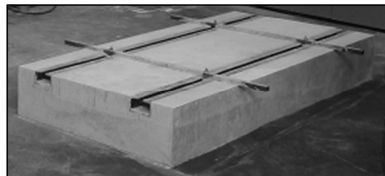
Figure 20 : dalle principale après séchage
