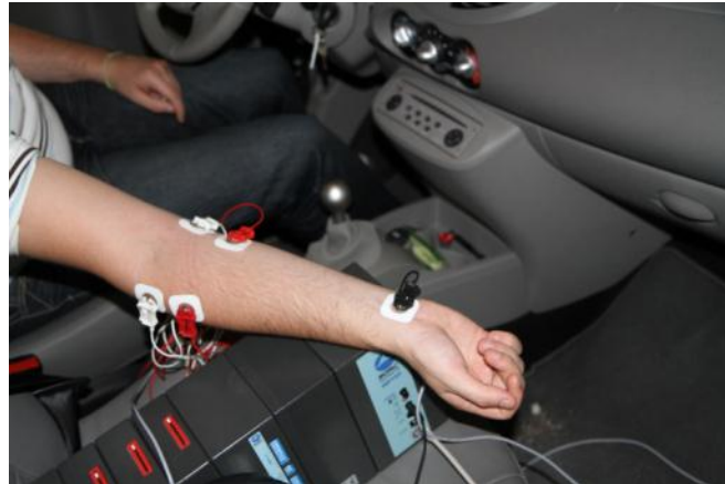
Fig. III-9 : Branchement des électrodes pour l'analyse des EMG
