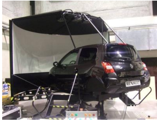
Fig. I-4. : Simulateur dynamique de conduite SAAM (Institut Image).
