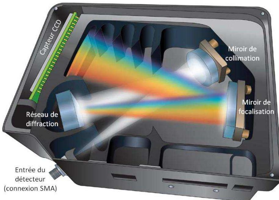
Figure 2.5. Schéma du système de détection Maya2000Pro [85].
