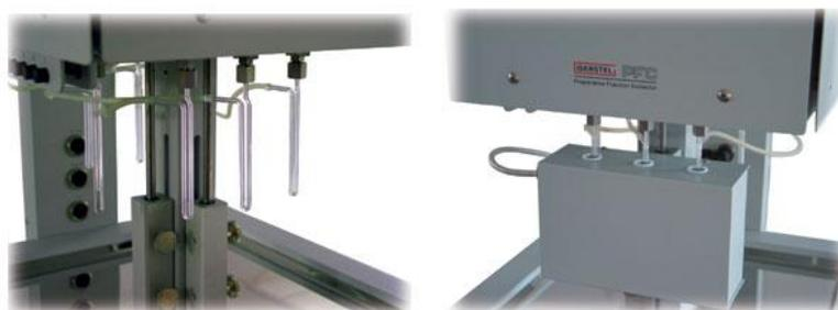
**Figure 6** : Le dispositif de piégeage cryogénique
