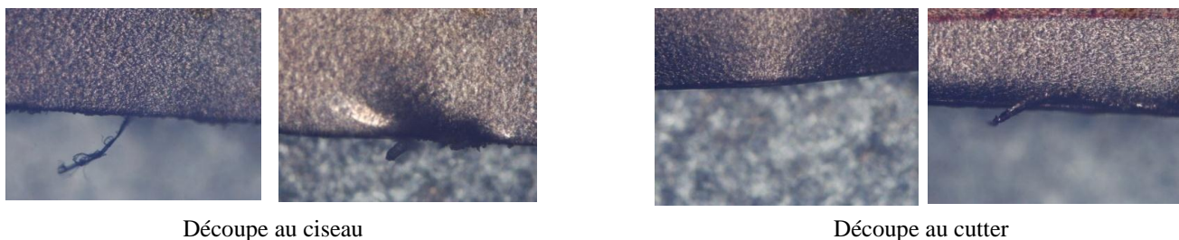
Figure 125 : Défauts créés lors de la découpe manuelle des électrodes.
