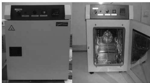
**Figure III. 21.** Etuve de laboratoire utilisé pour déliantage.
