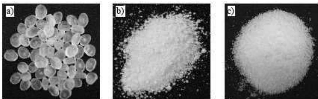
Figure II. 1. Description des liants utilisés: (a) polypropylène, (b) acide stéarique et (c) cire de paraffine [Kon\_2011].
