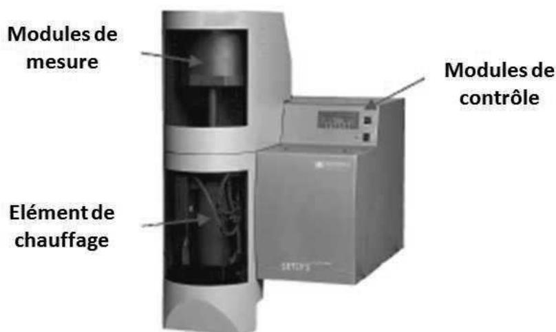
**Figure II. 8.** Description de l'analyseur thermogravimétrique Setaram Setsys evolution en configuration thermobalance ATG/DSC.
