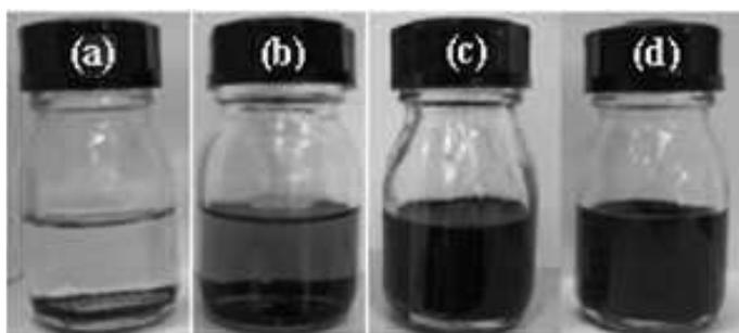
**Figure V. 3.** Comparaison des dispersions obtenues des NTC respectivement dans (a) l’eau, (b) acétone, (c) SDS et (d) acétone + liquide vaisselle.
