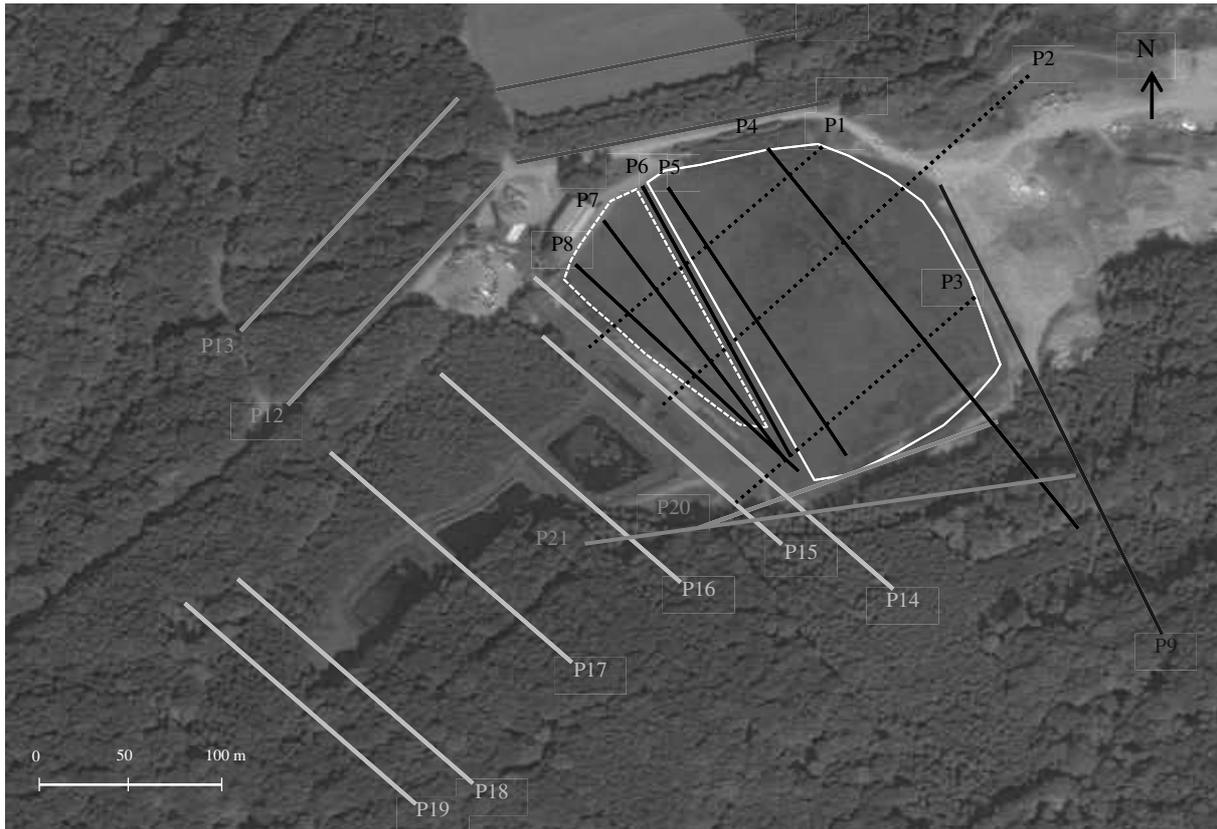
Figure 4.1 : Schéma d'implantation des profils électriques
