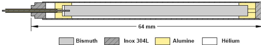
**Figure 36 : prototype d'un collectron gamma à isolant hélium et à émetteur bismuth cylindrique [88][89]**
