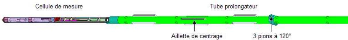
Figure 23 : Vue 3D d'une cellule montée sur son tube prolongateur
