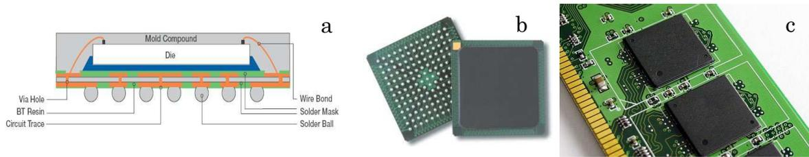
Figure 1 : packaging d'un circuit intégré. a- représentation schématique en coupe du packaging d'une puce sur un substrat type BGA<sup>2</sup>. b- exemple d'un boîtier BGA. c- boîtier BGA reporté sur un circuit imprimé.
