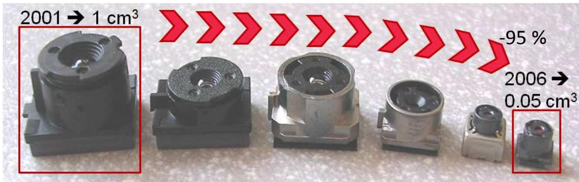
Figure 9 : évolution des tailles des modules capteurs d'images entre 2001 et 2006 (STMicroelectronics).
