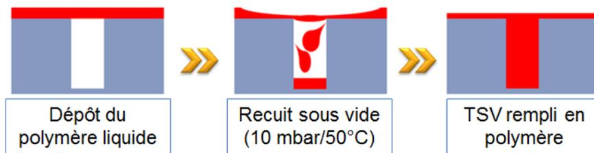
Figure 11 : remplissage des TSV par une solution polymère liquide. Conditions de recuit sous vide pour le polymère SINR.
