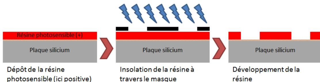
Figure 1 : représentation schématique des principales étapes du procédé de photolithographie.
