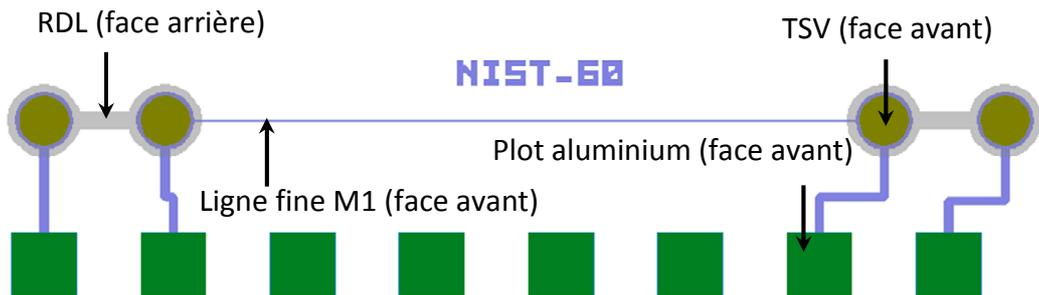
Figure 31 : motif NIST utilisé dans les tests d'électromigration. Les dimensions de la ligne fine de cuivre sont  $800 \mu\text{m}$  de longueur,  $0,5 \mu\text{m}$  de largeur et  $1 \mu\text{m}$  d'épaisseur. Sur cette vue, les niveaux des deux faces avant et arrière sont superposés.
