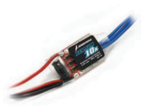
FIGURE 8.15 – Variateur Hobbywing Pentium10A utilisé pour contrôler le moteur Bruhless de la turbine de sustentation (dimension : 27 \times 17 \times 6 mm, masse : 9 g, fonction BEC : 5V/1A, courant max. continu : 10 A).
