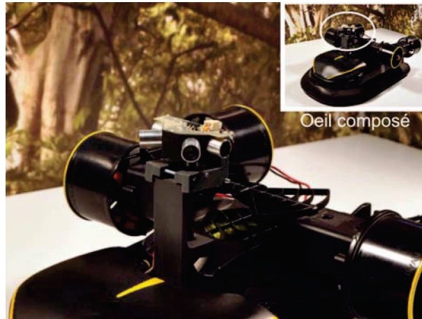
FIGURE 6.9 – Œil composé minimaliste monté sur le robot (photo encart) constitué de seulement 4 facettes comportant chacune 2 pixels. Chaque facette constitue un détecteur élémentaire de mouvement et estime le flux optique 1-D dans sa direction de visée (directions azimuthales \varphi_i = \pm 45^\circ et \varphi_i = \pm 90^\circ ).
