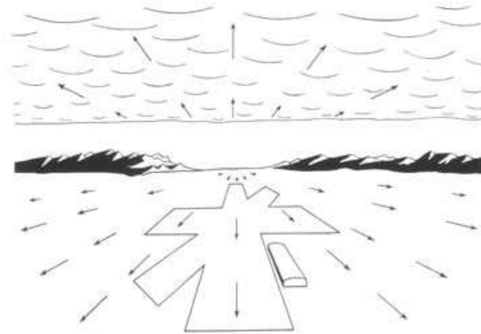
FIGURE 1.4 – Champ de flux optique généré sur la rétine du pilote par le mouvement de translation d'un avion à l'atterrissage. Chaque vecteur représente le sens et le module de la vitesse angulaire des fronts contrastés dans l'environnement. Le point au centre de l'image a une vitesse angulaire nulle : c'est par définition le foyer d'expansion ou pôle du flux optique. (D'après [Gibson, 1950]).
