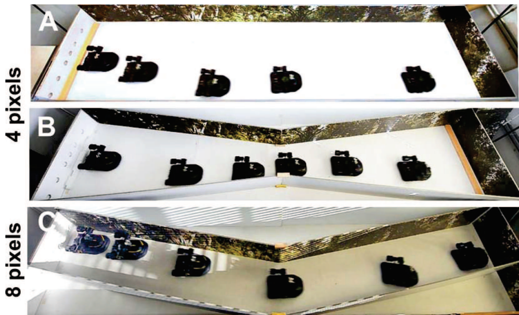
FIGURE 6.3 – Chronophotographies du robot LORA effectuant un suivi de paroi dans un tunnel droit (intervalle de temps : 1.12 s), fuselé (intervalle de temps : 1.83 s) ou présentant un virage (intervalle de temps : 2 s). Les trajectoires ont été obtenues avec le couple de consignes de flux optique \omega_{setFwd} = 190^\circ \cdot s^{-1} et \omega_{setSide} = 125^\circ \cdot s^{-1} .
