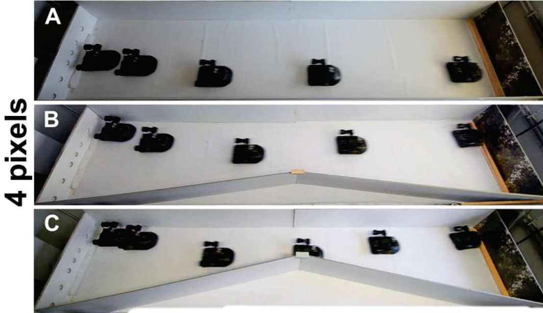
FIGURE 6.6 – Suivi de paroi de l'aéroglesseur miniature dans trois tunnels présentant une teinte uniformément blanche sur un des murs latéraux (trajectoires obtenues avec \omega_{setFwd} = 190^\circ \cdot s^{-1} et \omega_{setFwd} = 125^\circ \cdot s^{-1} ).
