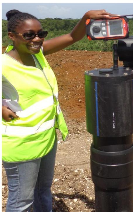
**Figure 34 Ing nieur S ch  Environnement r alisant une mesure de biogaz dans une t te de puits**
