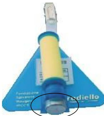
**Figure 31 Thermomètre code 126 (ACR Smart Button (entouré) + un adaptateur vertical Radiello)**
