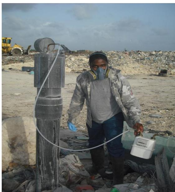
**Figure 64** Mesure du débit à la sortie du puits 42 par un technicien du laboratoire LARGE de l'UAG
