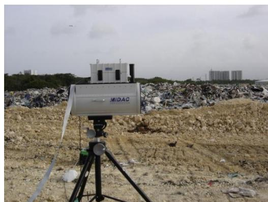
**Figure 39 Spectromètre M2400 de MIDAC à la Gabarre avec à gauche le récepteur et à droite la source**
