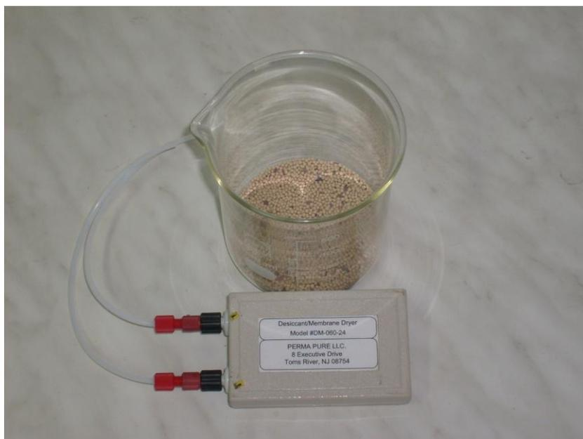
**Figure 50 Boîtier contenant le Nafion et l'ensemble tamis moléculaire plus silicagel (dans le bécher)**
