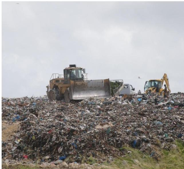
**Figure 13 Compacteur à pied de mouton (engin à gauche) en action à la Gabarre**
