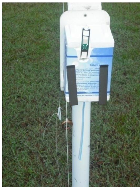
Figure 28 Boîtier contenant toutes les sondes de mesures + émetteur permettant contact avec satellite (vers le bas)
