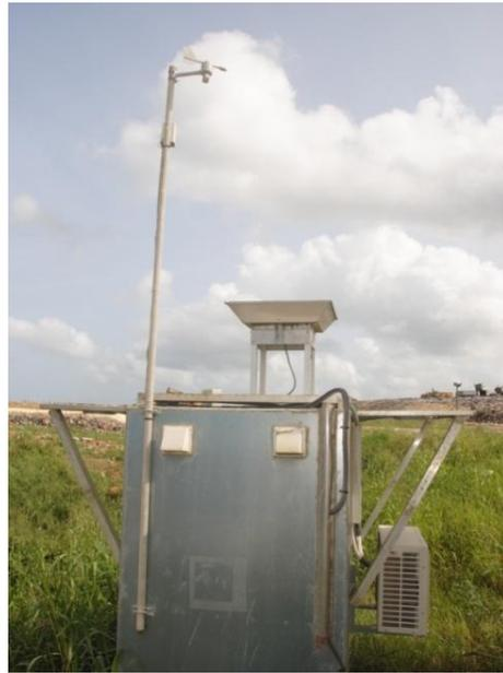
Figure 22 SODAR PA0 sur le site de la Gabarre avec l'antenne fixée au dessus du caisson
