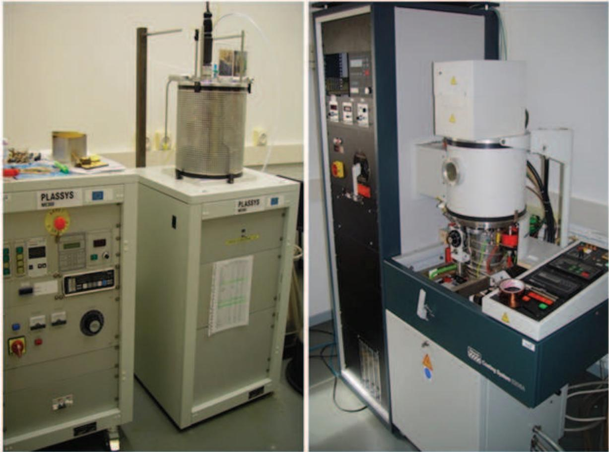
FIGURE 4.8 – Bâtis de dépôt : à gauche : évaporation ; à droite : pulvérisation magnétron.
