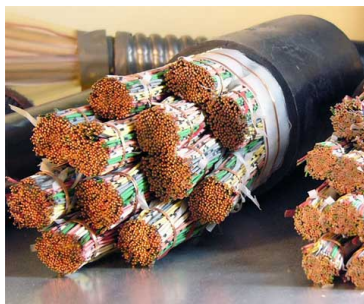
Figure 1.18 – Un toron de câbles.
