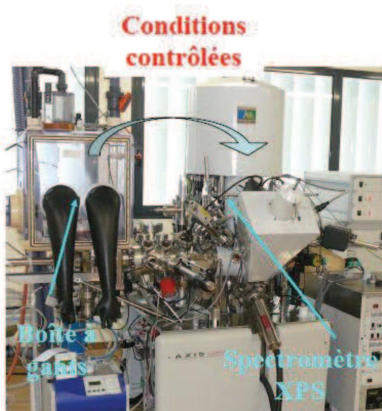
Figure A. 7. Photographie du spectromètre Kratos Axis Ultra utilisé.
