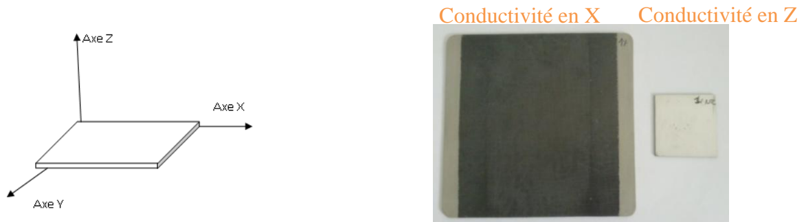
Figure IV. 16: plaque métallisée de (12*11.6) cm pour conductivité axe X (à gauche) et plaque de 4*4cm 2 pour conductivité axe Z (à droite)
