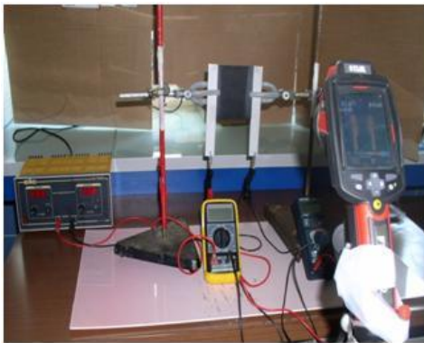
Figure IV. 18: Montages de mesure de conductivité, selon l'axe X (a) et selon l'axe Z (b)
