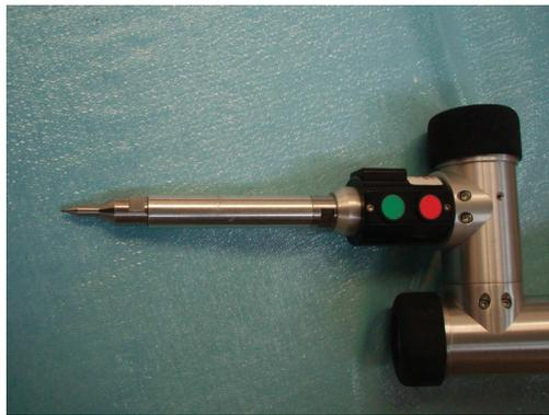
**Figure 63. Palpeur pointe utilisé**
