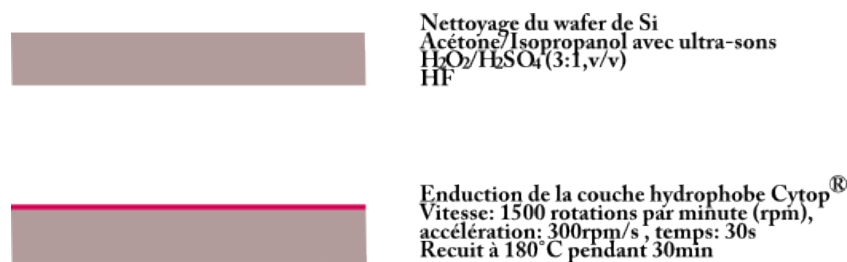
Figure 63:Etapes du procédé de réalisation des capots EWOD
