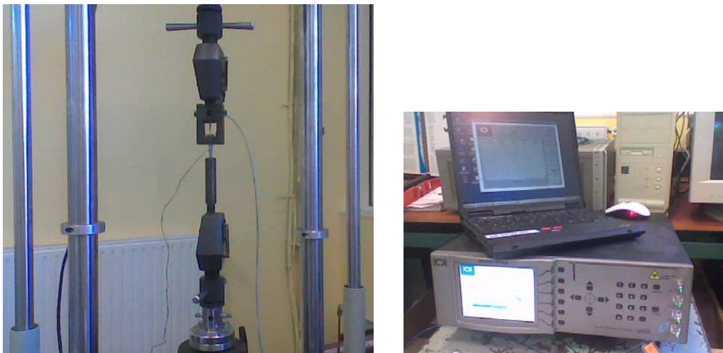
Figure 83 – Banc d'essai de traction et interrogateur en longueur d'onde
