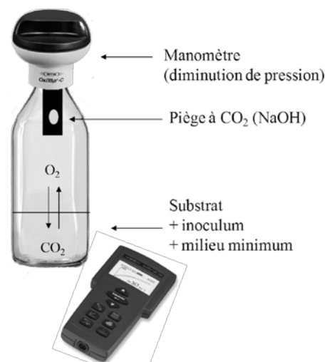
Fig. 38 - Dispositif expérimental des essais DBO OxiTop® (bioréacteur et boîtier de commande du manomètre)
