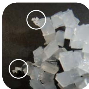
Fig. 51 - Photographie de l'élastomère RTV-1 DLDBE après 75 jours de dégradation en milieu basique (les excroissances observées sont encerclées)
