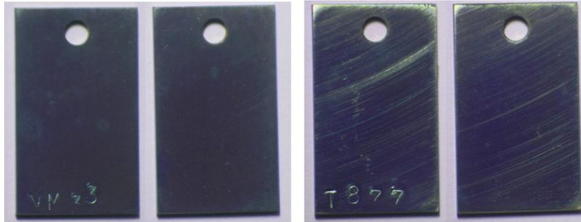
Figure 118 : Photos des échantillons suite test de corrosion n°16 : préoxydation- CO<sub>2</sub>+25000μbar d'O<sub>2</sub>- 2°C/min- 550°C- 250bar - 350h: a) acier Fe-12Cr, b) acier Fe-9Cr
