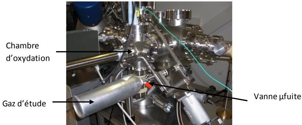
Figure 154 : Chambre annexe d'oxydation reliée à la chambre d'analyse XPS
