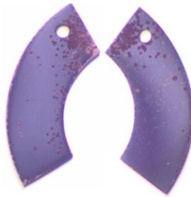
Figure 52 : Photo de l'échantillon suite au test de corrosion n°3 : Fe-12Cr- 150nm- He+1μbar d'O<sub>2</sub>- 2°C/min- 550°C - CO<sub>2</sub>+70μbar d'O<sub>2</sub>- 340h
