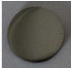
Figure 85 : Photo de l'échantillon suite aux tests d'oxydation réalisés à 330°C sous P=10<sup>-5</sup> mabr CO<sub>2</sub>
