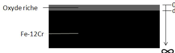
Figure 155 : Modèle de l'oxyde natif composé d'un film continu et homogène
