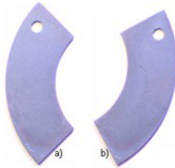
Figure 37: Photo des deux faces de l'échantillon après le test de corrosion n°1 : Fe-12Cr- 150nm- CO<sub>2</sub>+70μbar d'O<sub>2</sub>- 2°C/min - 550°C- 340h
