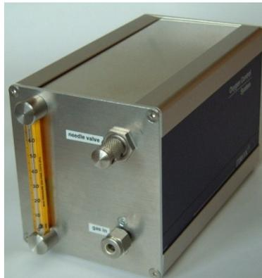
Figure 33: Photo de la sonde O<sub>2</sub> Zirox®
