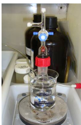
Figure 27 : Vue du montage de lixiviation à T = 50 °C de SLA2-104
