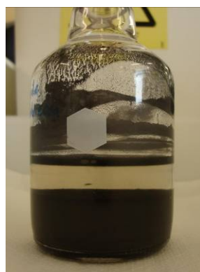
Figure 31 : Photos des deux "phases" de graphite après décantation
