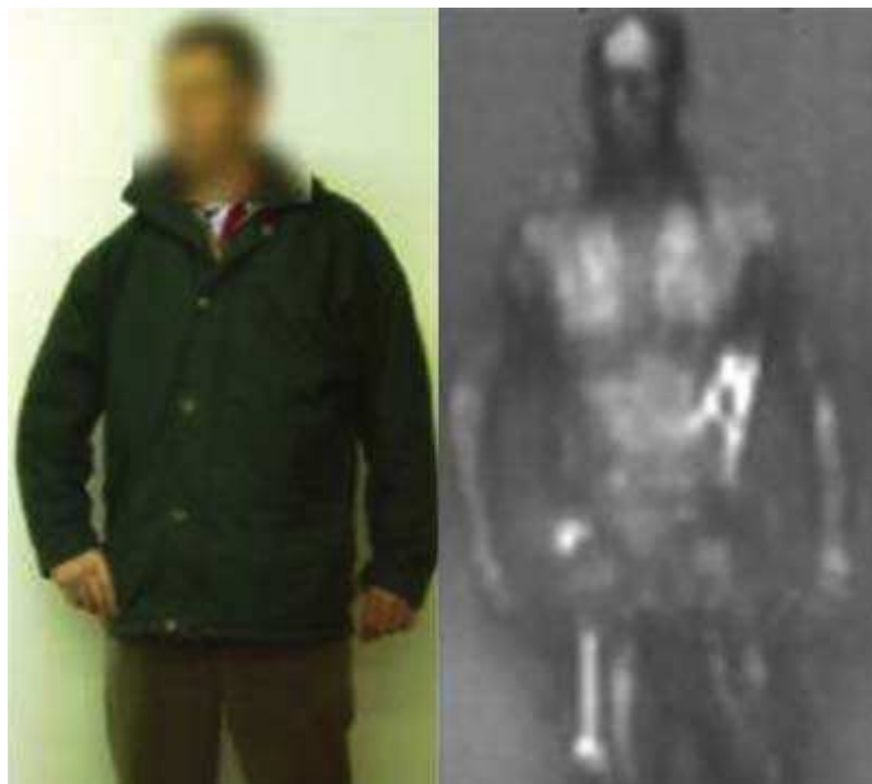
Figure I-3: Scanner corporel pour des applications sécuritaires
