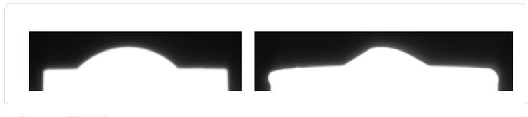
Figure 4.8: Clichés des angles de mouillage obtenus pour  $\text{TiSi}_2+20\%_{(vol)}\text{SiC}$  sur un substrat : (a) SiC CVD et (b) composite  $\text{SiC}_f/\text{SiC}$ .
