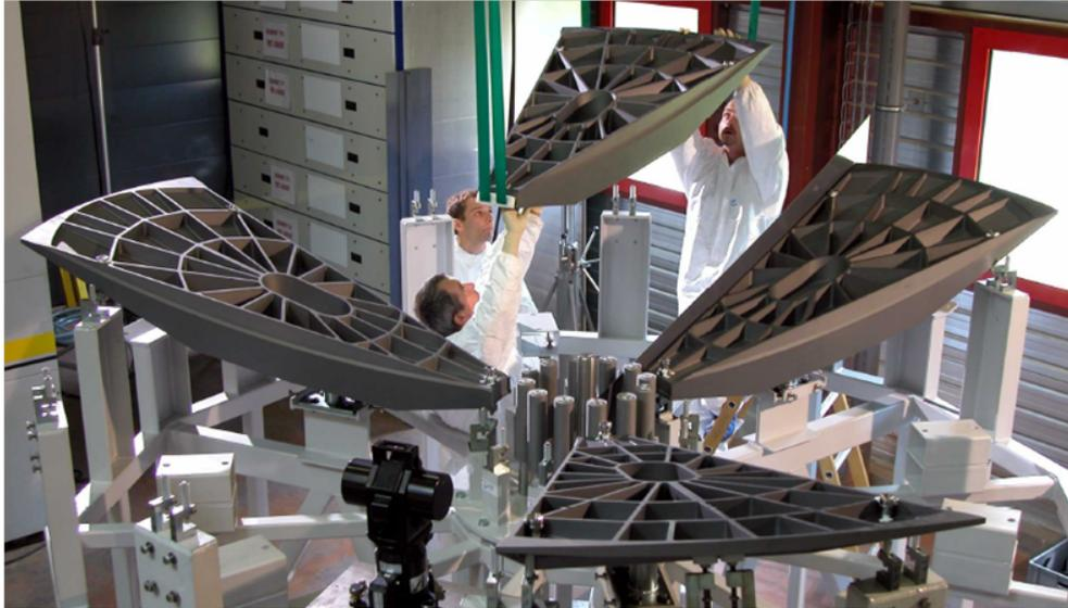
Figure 1.26: Cliché photographique d'un miroir de télescope Herschel brasé à l'aide de la brasure BraSiC<sup>®</sup>. (Source internet, site EADS Astrium)
