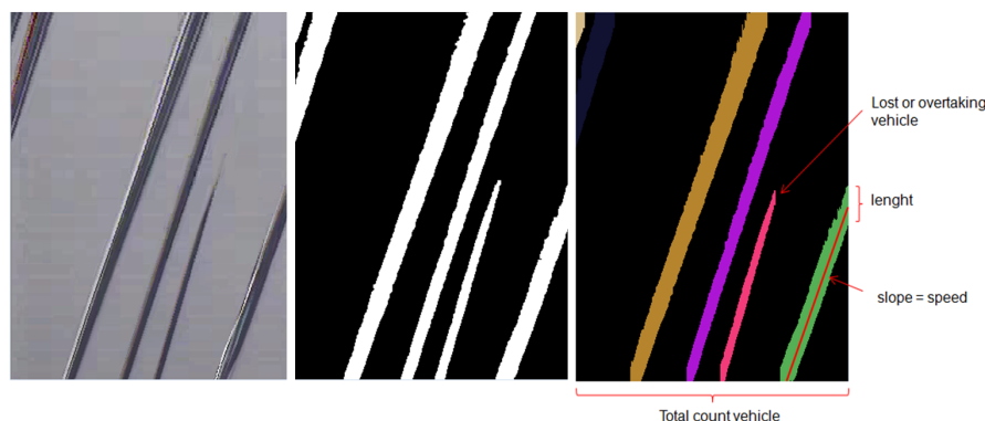
FIGURE 6.14: Exemple d'analyse couleur d'une carte spatio-temporelle ; la carte spatio-temporelle (à gauche) subit une soustraction d'arrière-plan (au centre) permettant d'extraire les objets (à droite).
