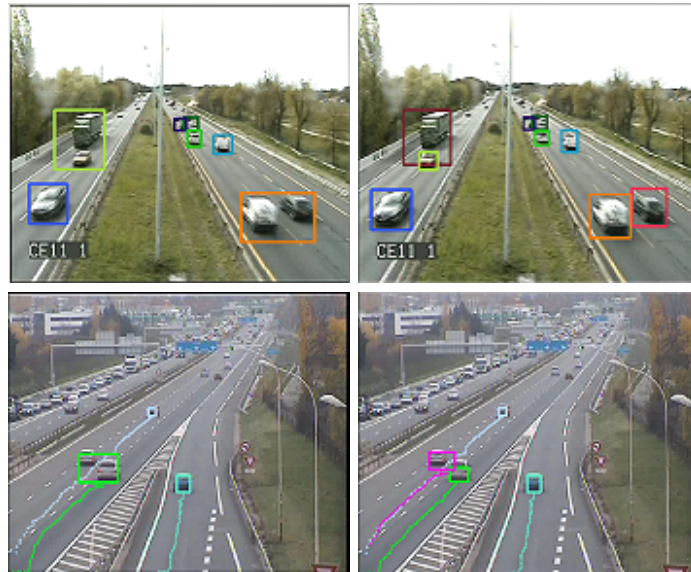
FIGURE 5.13: Exemple de correction apportée à la segmentation des objets en utilisant la structure du modèle de la scène. Les régions en mouvement sont correctement segmentées lorsqu'ils contiennent plusieurs objets
