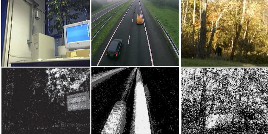
FIGURE 1.3: Illustration du nombre de composantes variables dans différentes scènes [Zivkovic 2004]. Le modèle de mélange comporte un nombre variable de composantes gaussiennes en fonction de la dynamique de la scène.
