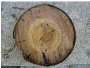
Figure 2. 13 Détermination de la surface de bois de cœur et d'aubier sur rondelle de 7 ans. A. eau, B. iode, C. Chlorure de Fer III (Photos FCBA).
