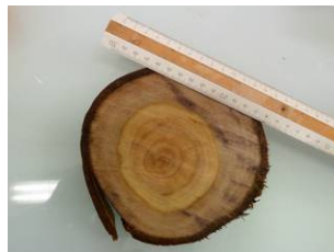
Figure 2. 13 Détermination de la surface de bois de cœur et d'aubier sur rondelle de 7 ans. A. eau, B. iode, C. Chlorure de Fer III (Photos FCBA).
