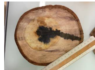
Figure 2. 13 Détermination de la surface de bois de cœur et d'aubier sur rondelle de 7 ans. A. eau, B. iode, C. Chlorure de Fer III (Photos FCBA).
