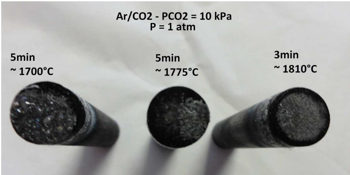
**Fig D.4** : Photographie de la surface inférieure des échantillons après traitements sous Ar/CO<sub>2</sub>, P<sub>CO<sub>2</sub></sub> = 10 kPa à pression atmosphérique
