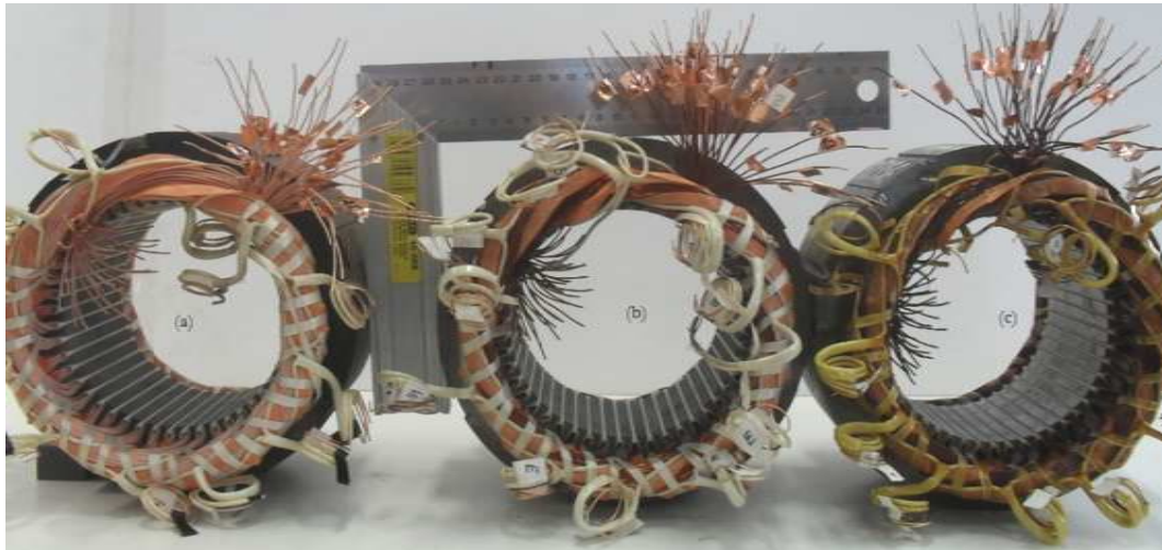
Figure 3-8. Stators bobinés avec du fil thermocollé polymérisé par UV (a), avec du fil thermocollé classique (b) et avec du fil imprégné classique (c)
