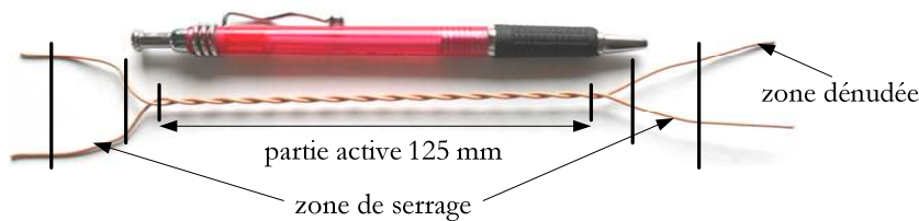
Figure 3-7. Echantillon d'une paire torsadée de fil émaillé selon la norme CEI 60172
