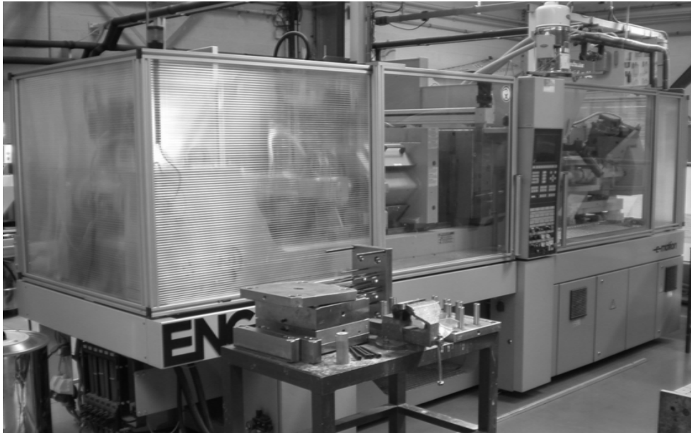
Figure 3-21. Moule & machine d'injection de la matière plastique au lycée plasturgie à Auchel (62)
