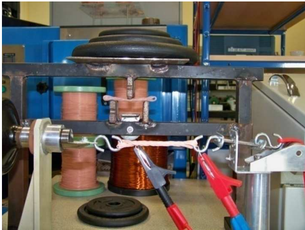
Préparation des éprouvettes normalisées et essai de test de collage
