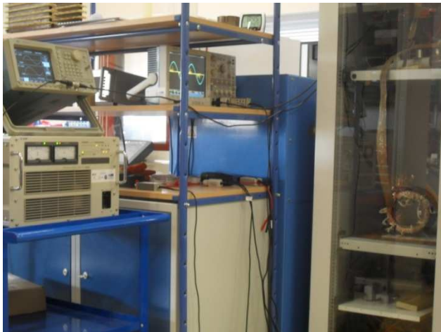
Source de tension à fréquence élevée et circuit de mesure de seuil de décharges partielles
