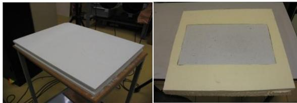
Figure III-11. Carreau de plâtre      Figure III-12. Béton cellulaire
