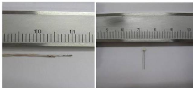
Figure III-4. Thermocouple de type T et Résistance de platine Pt100
