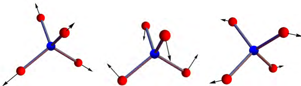
FIGURE 3.1 – Illustration des déplacements envisagés symbolisés par les flèches noires. De gauche à droite : Aucune brisure de symétrie (breathing mode), T_d \rightarrow D_{2d} et T_d \rightarrow C_{2v} (déformations tétraogonales).
